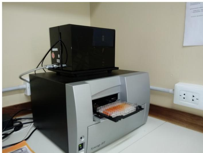
Figura 10: Lector de placas Biotek Synergy 2 con placa de ensayo de XTT.
